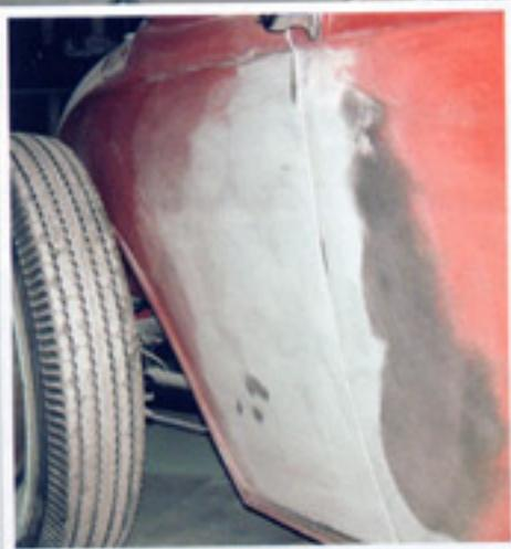
Hemma i garaget togs första steget när de grövsta ojämnheterna fylldes ut. Vi valde efter rekommendation att spackla med All-Metal direkt på plåtrenna ytor utan underliggande primer. Kvartspanelerna mot dörrkanterna är ett ställe som alltid behöver fyllas upp för att få samma form.
