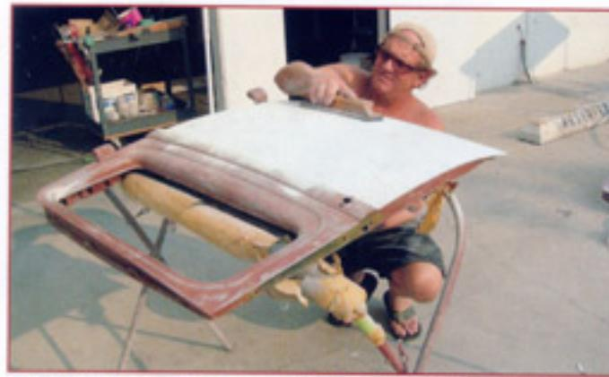
Dennis "Lil Daddy" Roth, som gör sin monsterkonst hos Spade Brothers, kom förbi och hjälpte till att slipa dörrarna. Efter att lagt på spackel i ett par omgångar och slipat mellan var det klart för att spruta på sprutspackel.
