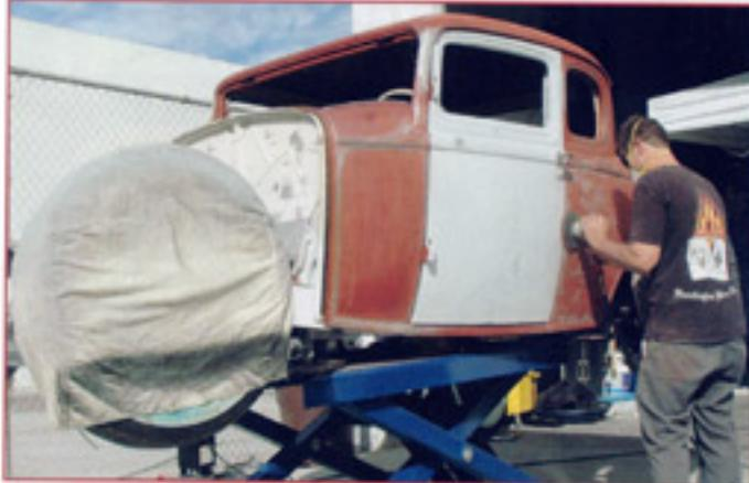
En viktig del av förberedelserna är att montera dörrar och baklucka på karossen och försäkra sig om att alla kanter mellan detaljerna fortfarande stämmer mot varandra. Sprayburksprimeren slipades bort helt och hållt innan man börjar lägga på spackel.
