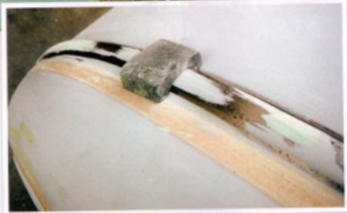
För den slutliga finslipningen behövdes även alla falsar på bakdelen av karossen slipas till en enhetlig form. En slippkloss tillverkades i All-Metal plast som passade falsen perfekt. Slippapper användes sedan i klossen för att få rätt form på båda sidor.
