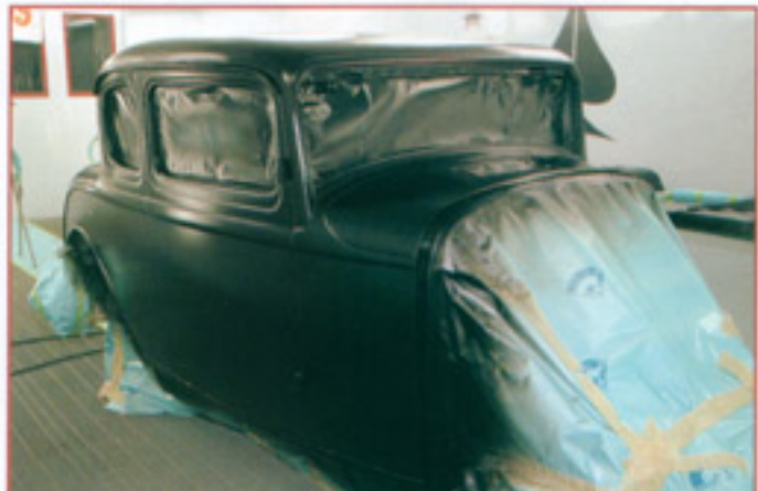
När planen ändrades till silverflake istället för en färgad flake byttes också basfärgen ut mot svart. Den gör det nämligen lättare att se när silverflaken täcker helt och hållet. Den svarta PPG-färgen blev halvmatt när den torkade.
