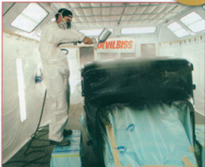
Shaun sprutar första varvet av flaken med det stora 2,2 millimeter munstycket i sprutan.
