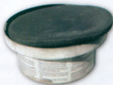
Till sista finslipningen med 320 papper använde vi ett färgpulver. Pulvret är lättare att slipa på den fina ytan man nu redan har.
