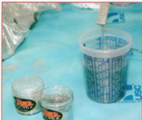
När planen ändrades till silverflake istället för en färgad flake byttes också basfärgen ut mot svart. Den gör det nämligen lättare att se när silverflaken täcker helt och hållet. Den svarta PPG-färgen blev halvmatt när den torkade.
