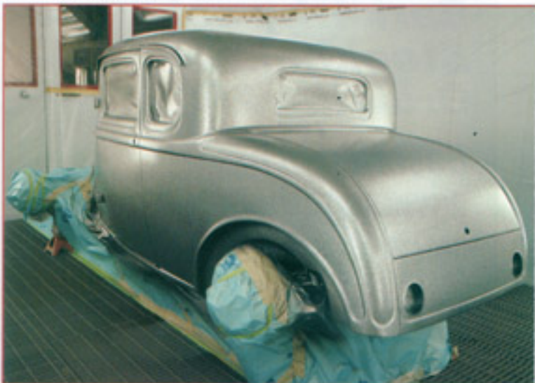
Med tre-fyra varv av den glittrande flaken började karossen se imponerande ut. En närmare titt avslöjade dock lite av det svarta mellan flakekornen. Alltså fler varv med flake.
